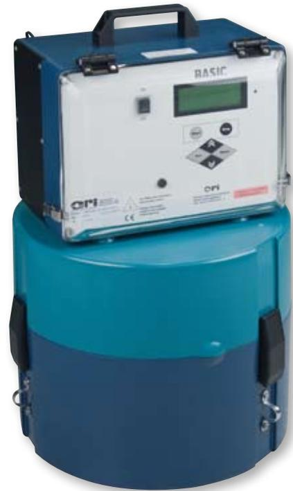
Préleveur d'échantillons portatif, modèle PB 25 S, avec système à pompe péristaltique et accu intégré pour un échantillon global de 26 l ainsi qu'un échantillon fractionné via un distributeur circulaire pour 12 récipients pour échantillons de 1 l, 24 pour échantillons de 0,5 l ou 24 pour échantillons de 1 l. Grâce à la détection sans contact de l'eau (en option) reliée à la commande, il est également possible d'échantillonner avec précision des eaux à conductivité très faible ou très élevée.
