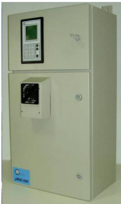
**MicroMac Phosphore Total** est un analyseur en ligne piloté par microprocesseur spécialement conçu pour la surveillance automatique du Phosphore Total sur différents types de matrices aqueuses.
