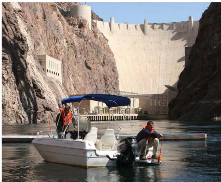
*CastAway™ est un outil multi fonctions qui intègre la technique disponible la plus avancée tout en restant simple d'utilisation. Elle est conçue pour le profil CTD jusqu'à 100 mètres avec un déploiement facile comme montré par cette photo prise au barrage Hoover.*
