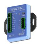
La sonde multi-paramètres YSI ExO peut s'interfacer en communication RS-485/RS -232 avec le protocole ModBus. Des liaisons numériques avec automate programmable, gestion technique centralisée, transmission à distance deviennent possibles, non plus au travers de simples signaux analogiques impré-
