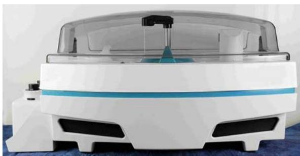
Le robot analyseur séquentiel EasyChem Plus est un instrument par voie colorimétrique. Flexible et performant, il est capable d'exécuter plusieurs tests diffé-
