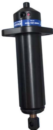
témoin sync VPS. La récupération à la demande de l'état du récepteur par communication avec le récepteur traqueur VT100 et l'hydrophone transpondeur : inclinaison, portée, température, énergie et mémoire des unités VR2AR, surveillance du nombre total de détections, ID spécifiques aux marques, quels récepteurs sont à portée du VR100, localisation des VR2AR perdus.
