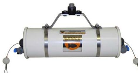
Bouteille de prélèvement horizontal Beta™
