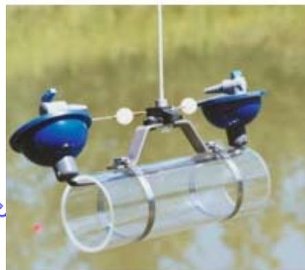
Bouteille de prélèvement horizontal Alpha™
