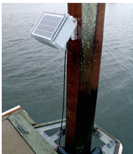
YSI PACS-1 : Alimentation solaire et communication Bluetooth avec des instruments immergés : sonde YSI série 6, courantomètre ADCP Sontek/YSI... via un PC et un dongle Bluetooth
