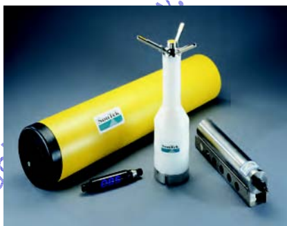
Configuration autonome ADVOcean Hydra de Sontek avec capteurs de pression, de turbidité, conductivité et température
