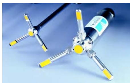
Sonde 10cm de l'ADV 10MHz montrée à côté de l'ADVOcean 5MHz standard avec son corps en acier inoxydable
