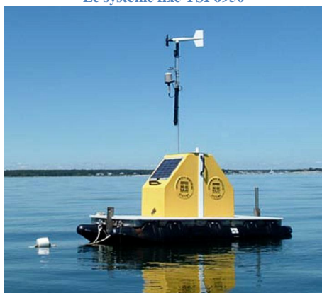
Le système YSI 6951 installé sur ponton avec capteurs météo
