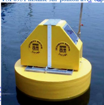
Le système YSI 6952 intégré sur bouée compacte
