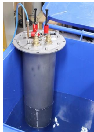
Test d'étanchéité du conteneur des électroniques
