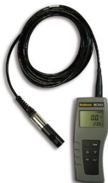
L'EcoSense® EC300A est conçu pour donner des résultats rapides et précis avec une plateforme économique. C'est la possibilité de mesurer conductivité, salinité ou TDS et température avec un instrument simple et compact utilisable sur de nombreuses applications.
