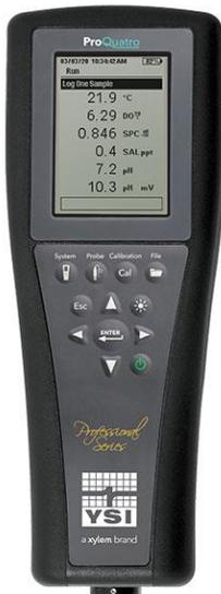
L'YSI ProQuatro avec un câble de terrain Quatro vous permet d'utiliser ses 4 ports pour mesurer température/conductivité, O2d avec deux électrodes parmi pH, redox, ammonium, chlorures ou nitrates, créant ainsi un appareil multi-paramètres extrêmement puissant.
