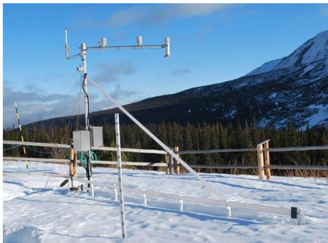
*Le système SPA enregistre automatiquement et en continu tous les paramètres importants du pack neigeux, permettant par exemple les prédictions sur la progression de la fonte. Cette dernière génération SPA-2 offre une nouvelle interface encore plus conviviale, une connexion de capteurs analogiques simplifiée et de nouvelles possibilités de sorties en RS-485 ou SDI-12.*
