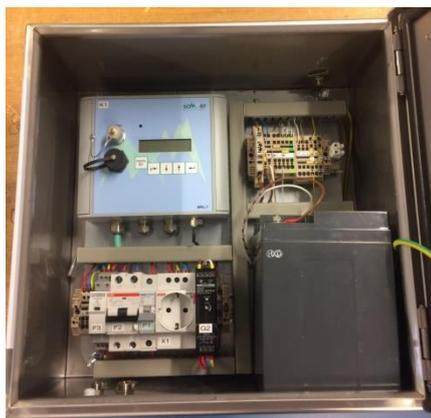
Toutes les centrales Sommer MRL-6 et MRL-7 peuvent être livrées installées en coffret acier inoxydable câblé avec espace pour batterie 28Ah ou 72Ah, connexion arrivée du secteur, connexion avec régulateur pour entrer d'un panneau solaire, porte fusibles/disjoncteur, bornes de raccordement...
