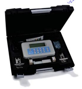
Commander le jeu de sondes 'A' pour des conduites de diamètre externe 13 à 115mm) ou le jeu 'B' pour les conduites entre 50 et 1000 mm. Utilisation sur tout matériau solide, métal ou plastique.
