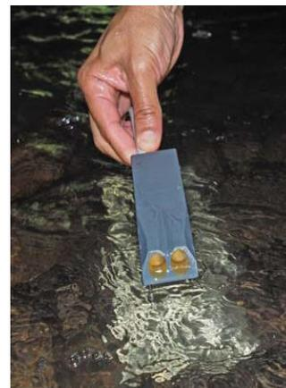
L'enregistreur Pulsar MantaRay utilise une sonde immergée à ultrasons, installée au fond d'un canal ou d'une conduite en charge partielle. Elle n'a pas de pièces en mouvement ni d'orifice, ou électrodes. Le câble de sonde, le boîtier électronique IP67 sont conçus pour résister à l'encrassement et à la corrosion.
