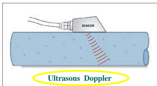
Les débitmètres Doppler fabriqués par Pulsar Measurement utilisent une sonde mono transducteur, ceci permet un montage rapide et simple sur l'extérieur de la conduite. La sonde mono transducteur intègre les cristaux d'émission et de réception dans un même corps.
