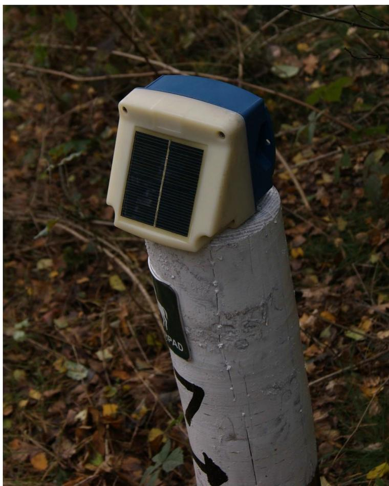
OMC-043-01 avec panneau solaire intégré, installée en tête de forage
