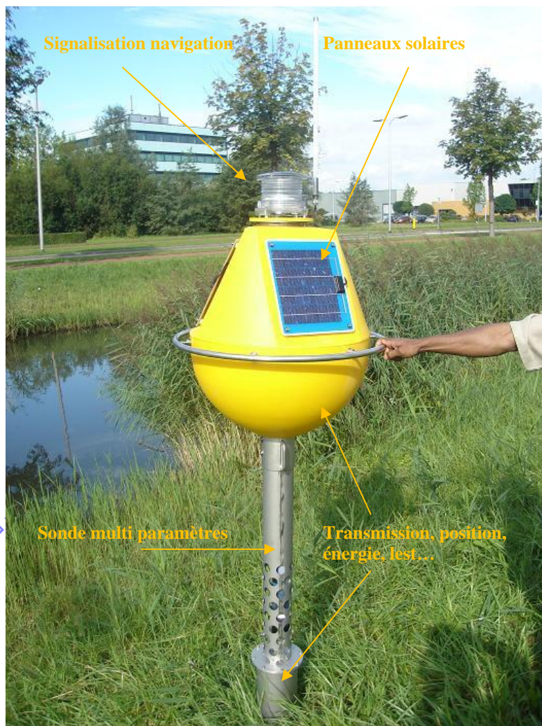
La bouée compacte OMC 7006 est facilement manipulée à la main
