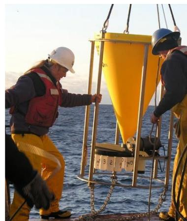
Pièges à sédiments passif et à carrousel
