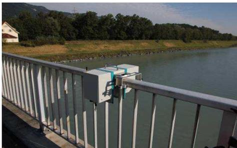
Radar sur rambarde de pont
