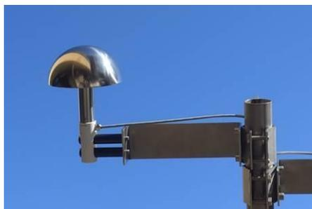
Pluviomètre – Distromètre acoustique
