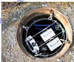
Système mobile sans contact par **radar Doppler** pour canaux à surface libre artificiels, enregistreur ou enregistreur + transmission GSM et batterie externes.
