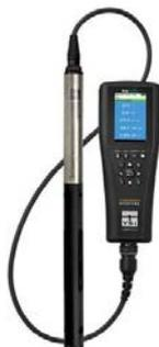
Passer d'un capteur numérique à un autre c'est possible avec le Terminal ProSwap. Ses câbles intègrent une sonde de température et en option de profondeur, ProSwap peut se transformer selon vos désirs en un turbidimètre de terrain ou un oxymètre optique de haute précision ou un pHmètre d'échantillonnage ponctuel ou un système CTD de profil vertical conductivité-température-profondeur. Même le contrôle de prolifération de cyanobactéries devient pos-
