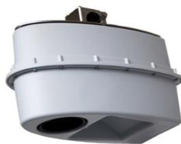
Débitmètre poste fixe sans contact par **radar Doppler** pour canaux à surface libre artificiels, avec 2 sorties 4-20mA et impulsions, RS-485, ModBus & SDI-12. Mesure Vitesse & Niveau, calcul interne du débit.
