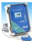
Débitmètre en ligne **Doppler**, affiche, totalise, transmet et commande en fonction du débit mesuré par une sonde bridée à l'extérieur de la conduite. Mesure sur liquides sales et sur une grande plage de diamètres.
