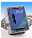
Détecteur de débit **Doppler** pour la protection des pompes, sonde bridée à l'extérieur de la conduite, tous diamètres à partir de 12,5mm jusqu'à 4,5 mètres
