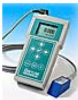
Débitmètre enregistreur, autonome & portable à ultrasons, **Doppler**, avec sonde à brider sur conduite. Diagnostics rapides de débit. Mesure sur liquides sales.
