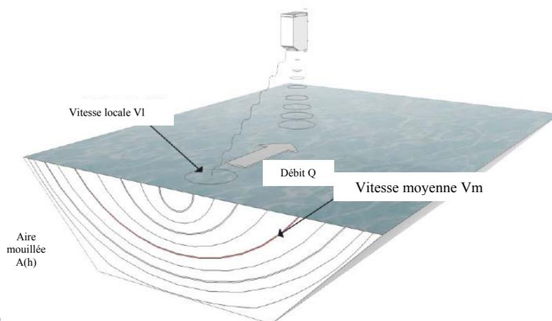
**Graphe : Profil de vitesse et section transversale**
