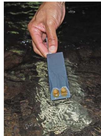
L'enregistreur MantaRay utilise une sonde immergée à ultrasons, installée au fond d'un canal ou d'une conduite en charge partielle. Elle n'a pas de pièces en mouvement ni d'orifice, ou électrodes. Le câble de sonde, le boîtier électronique IP67 sont conçus pour résister à l'encrassement et à la corrosion.
