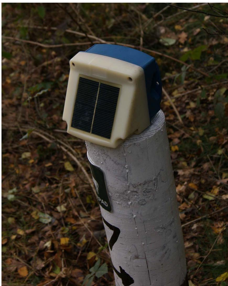
OMC-042 avec panneau solaire intégré, installée en tête de forage
