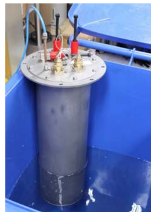
Test d'étanchéité du conteneur des électroniques
