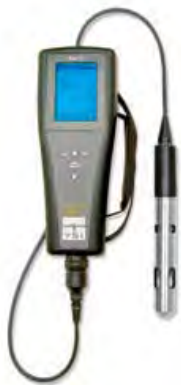
Figure 12 – Le Pro20 comme le ProPlus peut être combiné avec une sonde polarographique ou galvanique.
