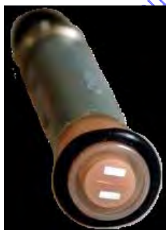
Figure 19 – Illustration des trois électrodes du capteur RapidPulse™
