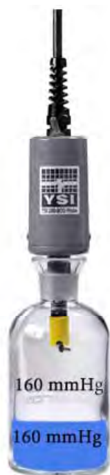
Figure 37 – La pression d'oxygène en air saturé d'eau et en eau saturée d'air est 160mm Hg au niveau de la mer.
