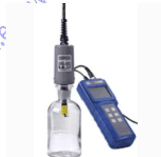
En communication directe PC ou avec entrée des valeurs au clavier, BOD Analyst Pro™ calcul les valeurs de DBO avec précision et dans le cadre requis par l'assurance qualité
