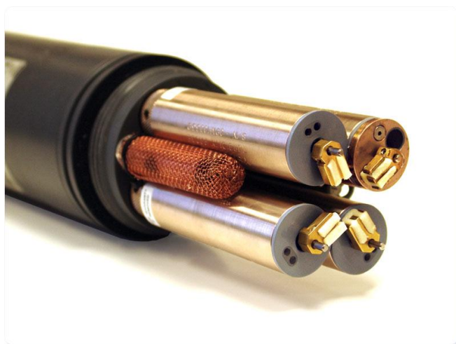
Capteur de turbidité par infra rouge YSI 6436 sur sonde YSI 6600V2-4
