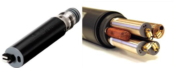
Capteur cyanobactérie ó version anti-fouling sur sonde YSI 6600V2-4
