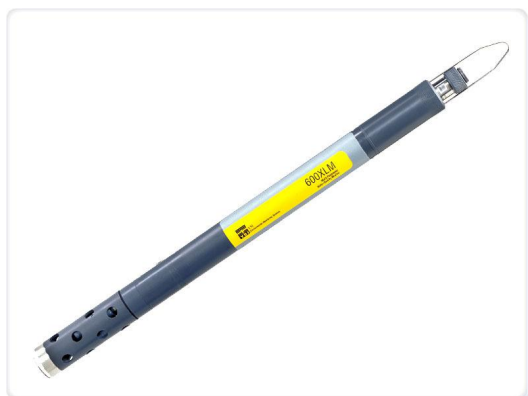
La sonde YSI 600XLMV2 avec son embout de protection lesté accueille un jeu de piles alcalines standards pour 75 jours d'enregistrement autonome
