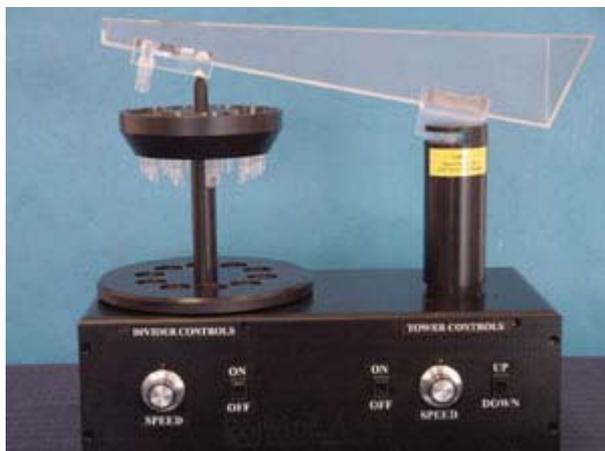
Le diviseur d'échantillon humide [McLane Parflux WDS-10](#) est conçu pour diviser un échantillon humide de particules en cinq ou dix parts égales, sans devoir auparavant sécher l'échantillon. Avec une destruction et une contamination minimales de l'échantillon du piège, le WSD-10 est particulièrement adapté à la préparation de haute précision des analyses biochimiques. Le diviseur est couvert d'une garantie de 36 mois.
