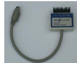
Convertisseur de signal analogique 0Vcc ou 4-20mA ou signal d'alarme 5Vcc
