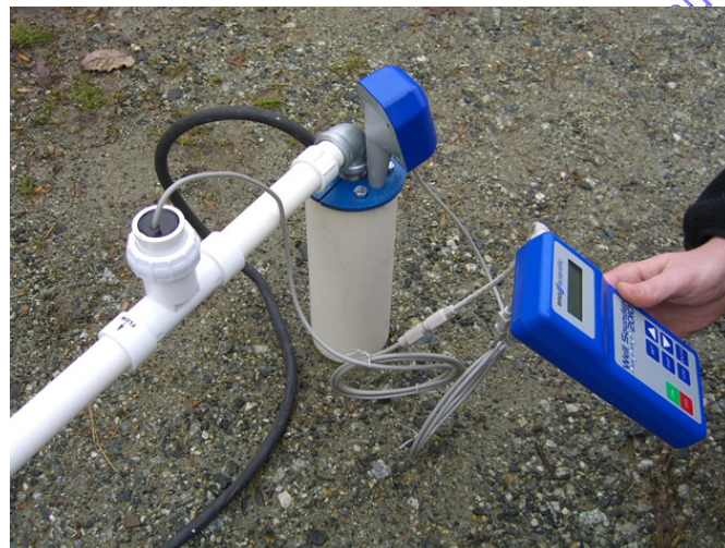
Le débitmètre montré en utilisation avec le 2010 PRO.
