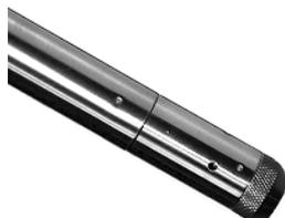
Une sonde pression/température à enregistreur intégré, l'AquiStar® PT2X est idéale pour surveiller l'eau souterraine, un forge, une cuve et la marée, mais aussi un test de pompage et contrôler un débit. Construite en inox 316 (ou titane), fluoropolymère et PTFE, cette sonde délivre des lectures de haute précision ( $\pm 0,06\%$  SPE typique) en conditions de terrain rudes et corrosives.
