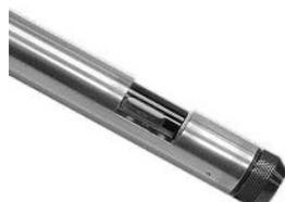
L'AquiStar® CT2X est une sonde intelligente, submersible de conductivité/température avec enregistreur interne ; dotée d'une cellule 4 électrodes époxy/graphite, cette sonde est extrêmement durable--excellente en conditions rudes. Cette technique réduit les erreurs : interférences de frange, imprécision par effets de polarisation et résistance de contact.
