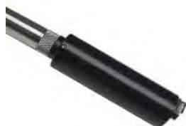
La sonde intelligente Aquistar® Turbo enregistre turbidité & température sur 250 000 lectures horodatées ; elle opère à faible énergie et se distingue par son logiciel puissant et convivial. Son microprocesseur opère en 12Vcc et cycle automatiquement le détecteur de turbidité comme requis pour économiser l'énergie. Le racleur nettoie la zone optique à chaque fois que le système de détection est mis sous tension.
