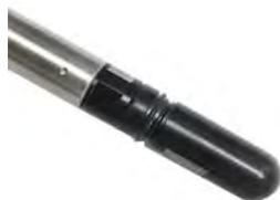
L' Aquistar® TempHion™ est une sonde intelligente submersible avec enregistreur, capable de mesurer pH, ions spécifiques, redox et température. Chaque unité est livrée avec un élément thermistance pour la température, plus un élément pH, ISE ou redox. Comme les CT2X & PT2X, cette sonde se distingue par son petit diamètre (19mm), une faible consommation et un double protocole (Modbus® & SDI-12).
