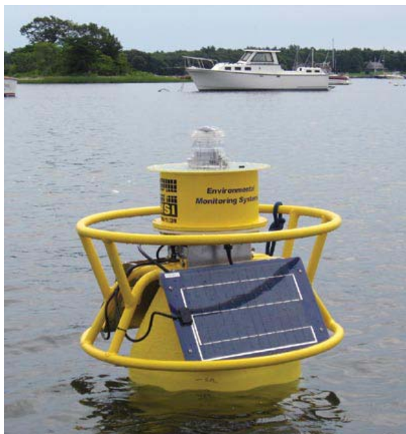
La bouée YSI EMM60 est légère et donc facile à déployer depuis une embarcation ou le rivage
