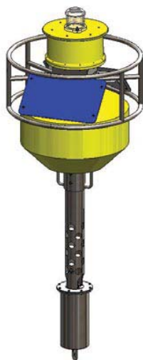
La bouée porte une sonde multi paramètres ici une YSI 6600V2-4 dans son tube sous surface
