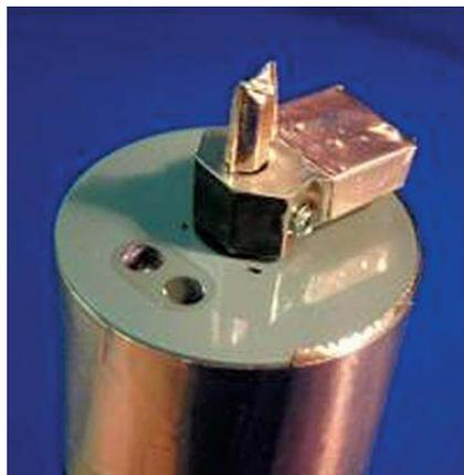
Retrofit d'un capteur optique avec grand racleur, ruban cuivré autour du corps, de l'axe de racleur et du racleur
