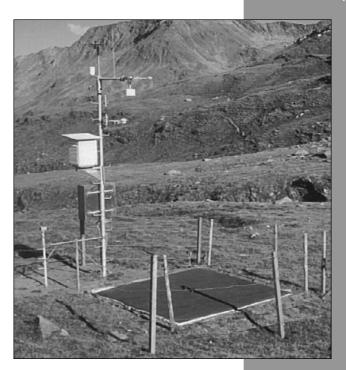
Le capteur est un équipement idéal complémentaire aux stations météorologiques. La combinaison avec un capteur de hauteur neigeuse, le Sommer USH-8 par exemple, permet un calcul simple et facile de la densité moyenne de la neige.
